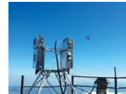
Misure simultanee delle specie di mercurio atmosferico presso un sito a terra sul vulcano Etna e voli aerei sul vulcano per la determinazione delle concentrazioni di Hg nel profilo troposferico
