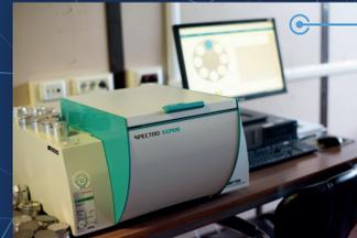
Spettrofotometro a fluorescenza di raggi X a dispersione di energia
